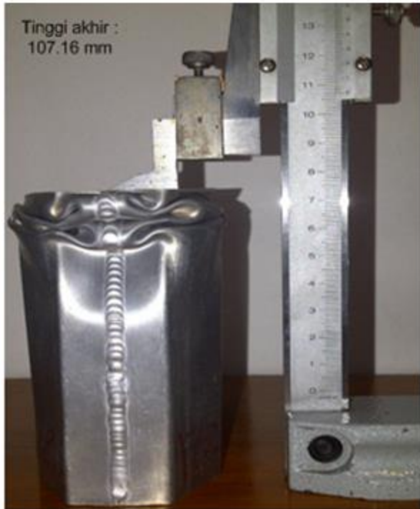
Deformasi segi-empat keliling 173.34 mm
