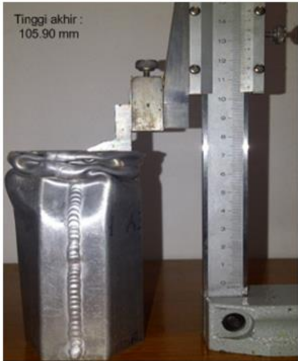
Deformasi segi-empat keliling 158.92 mm
