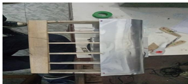
Gambar 3. Tampak atas prototype antiicing pada air foilclark Y
