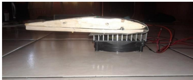
Gambar 2. Tampak samping prototype antiicing pada air foilclark Y
