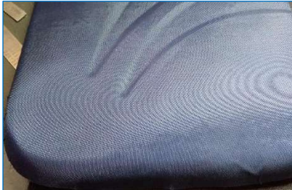
Gambar 8.13 Jenis Defect Bahan Cetakan Miring
