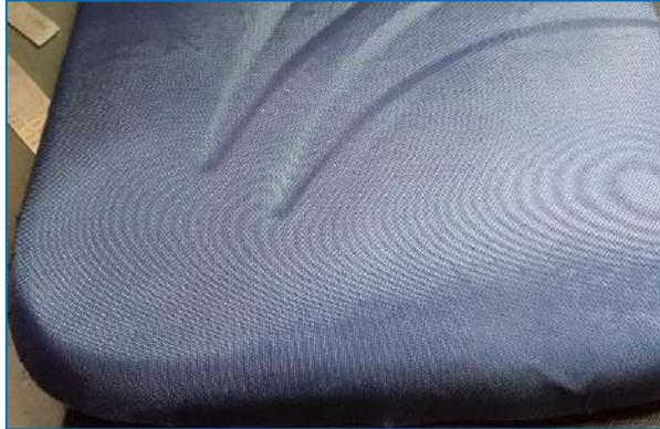
**Gambar 8.13 Jenis Defect Bahan Cetakan Miring**
