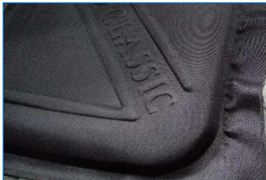
**Gambar 8.14 Jenis Defect Bahan Koper Bergelembung**
