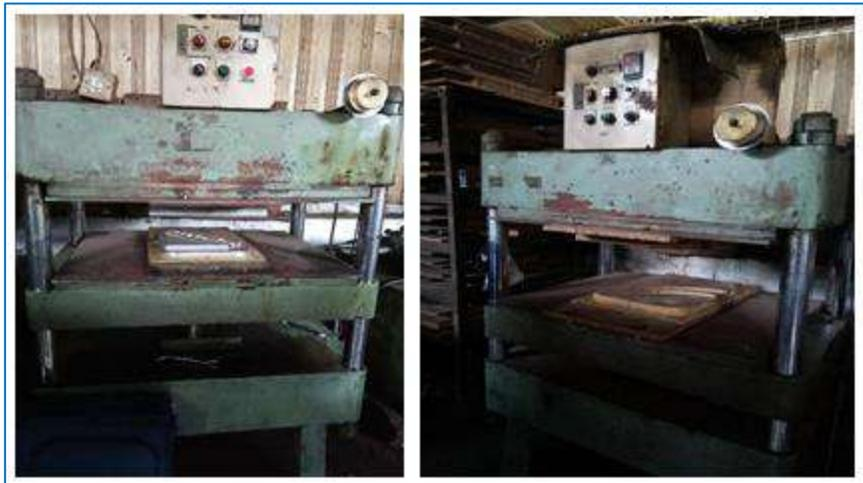
**Gambar 8.9 Mesin Cetak Besi dan Kayu**
