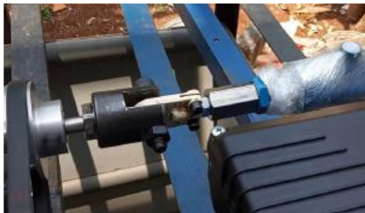
Gambar 4.26. Rod end penghubung antara poros aktuator dengan aktuator hidrolik
