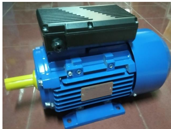
Gambar 4.15. Motor Listrik Induksi yang digunakan sebagai generator
