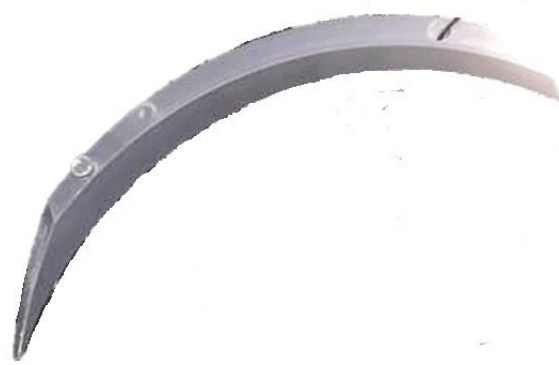
Gambar 3.14. Pembuatan blade impeller dengan 3D Printing
