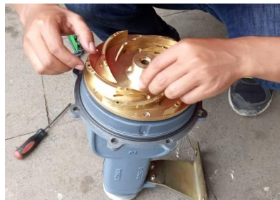
Gambar 4.11. Pemasangan blade impeller yang dapat di kontrol
