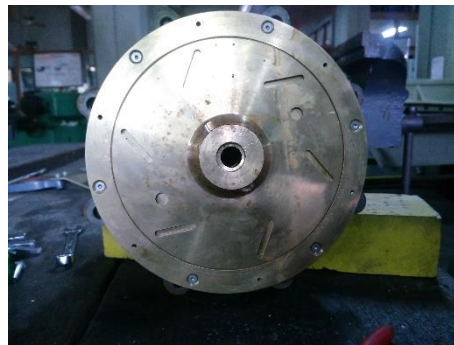
Gambar 4.9. Outer dan inner base impeller yang sudah terpasang
