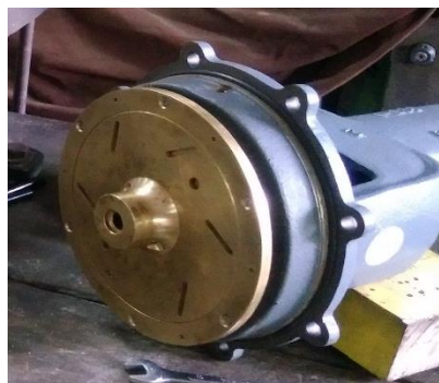
Gambar 4.10. Base Impeller yang dimasukkan kedalam pompa
