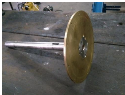
Gambar 4.7. Base impeller yang terpasang pada shaft impeller
