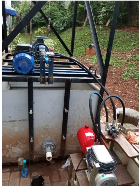
Gambar 4.27. Komponen hidrolik penggerak aktuator
