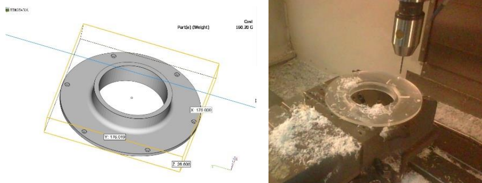
Gambar 3.15. Pembuatan mock up cap impeller
