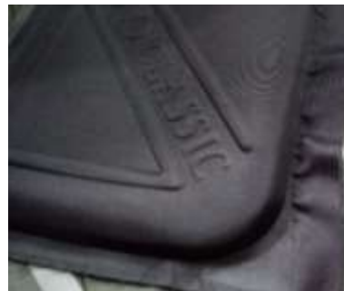
Gambar 8 Jenis Defect Bahan Cetakan Miring
